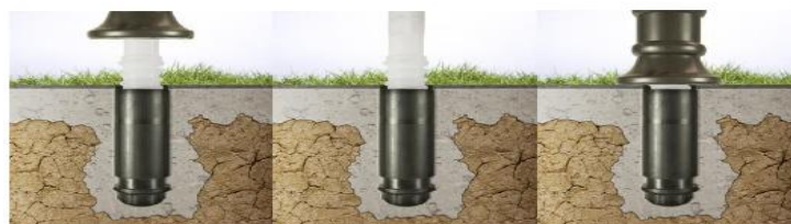
Colocación de la pylona
